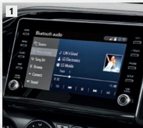
**1** Avec son écran couleur tactile 8" haute résolution (semblable à celui d'une tablette), le système multimédia **Toyota Touch® 2** vous offre un accès simple et rapide à toute une gamme de divertissements et de fonctionnalités. Il dispose d'un système audio de qualité, avec système Bluetooth®<sup>(1)</sup> et port USB.
