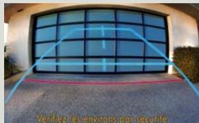
**Caméra d'aide au stationnement arrière.<sup>(5)</sup>** Faites marche arrière en toute sécurité avec la caméra de recul. Il vous suffit de contrôler l'environnement en suivant les lignes de guidage affichées sur votre écran.
